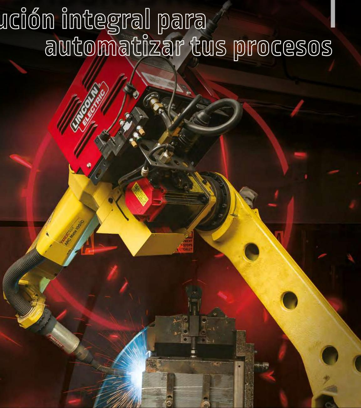
Los paquetes completos de vestidura para robots de soldadura de Lincoln Electric incluyen la fuente de soldar robótica, alimentador robótico, pistola robótica, brackets y dress out kit, facilitando la integración de los componentes en diversas marcas de robots.
