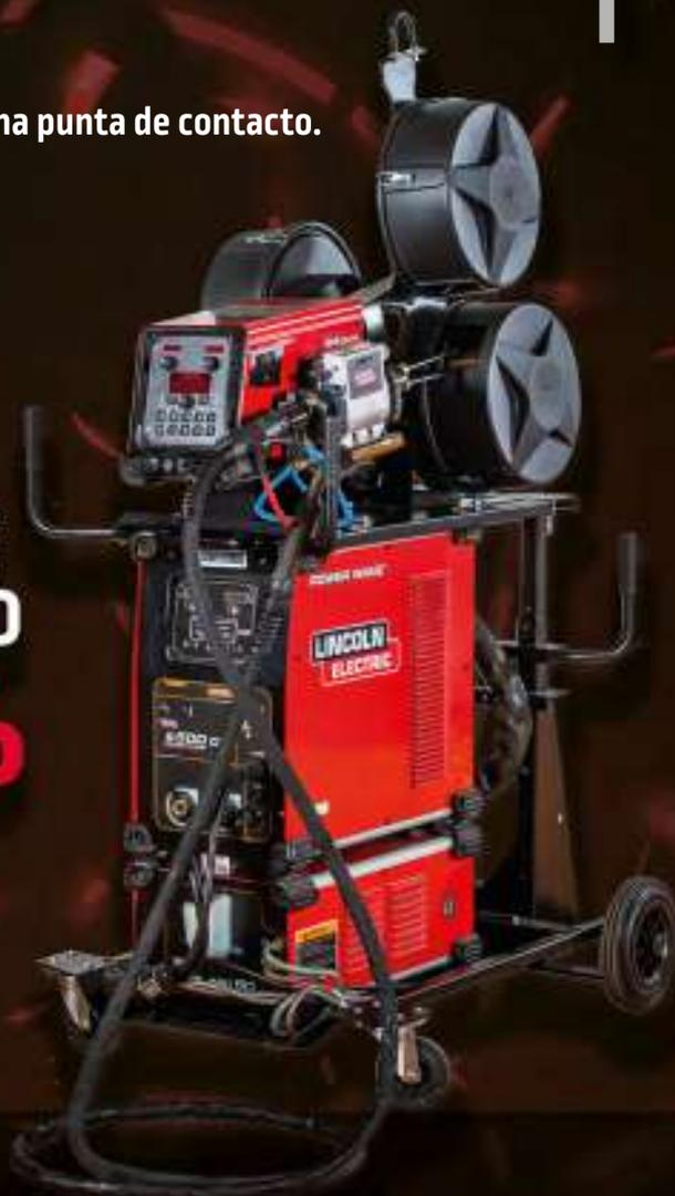
Con su innovador diseño de doble alambre, Hyperfill® permite tasas de depósito superiores a 8 kg/hr (11 kg/hr en aplicación robótica) sin comprometer la calidad de las soldaduras o la facilidad de uso del operador.
