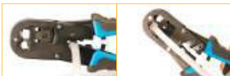
Corte de cables de red
